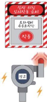
• 출입구 또는 비상구까지의 이동거리가 10m 이상인 방호구역과 이산화탄소가 충전된 소화용기를 100개 이상(45kg 용기 기준) 보관하는 소화용기 보관장소에는 산소 또는 이산화탄소 감지 및 경보 장치를 설치하고 항상 유효한 상태로 유지하여야 합니다.
