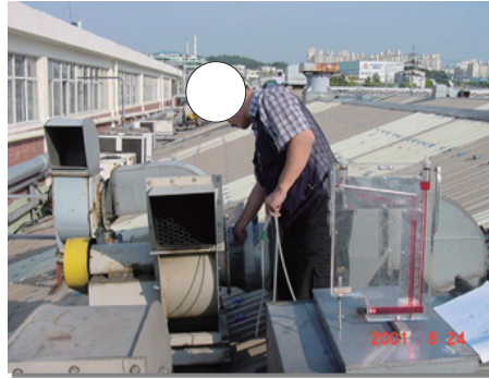
(b) 마노미터를 이용한 정압 측정
