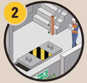
2 안전난간 및 덮개 설치
