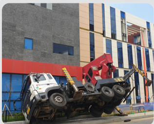
하중센서 임의해제 후 최대 작업 반경을 초과하여 작업 중 차량 전도로 사망 2021. 7.
